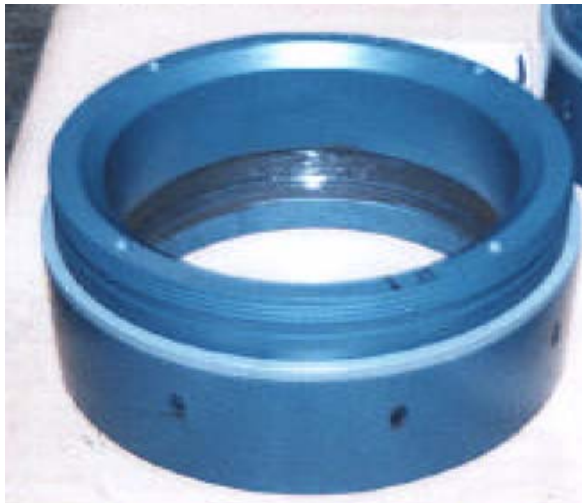
Figura 31. Sello packoff para sistema multitaza.
