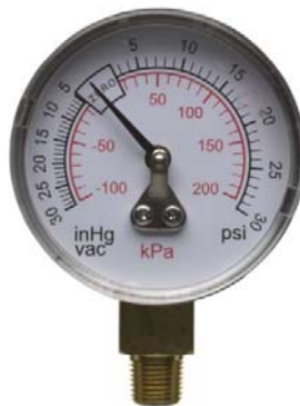
Figura 48. Manómetro tipo Bourdon
