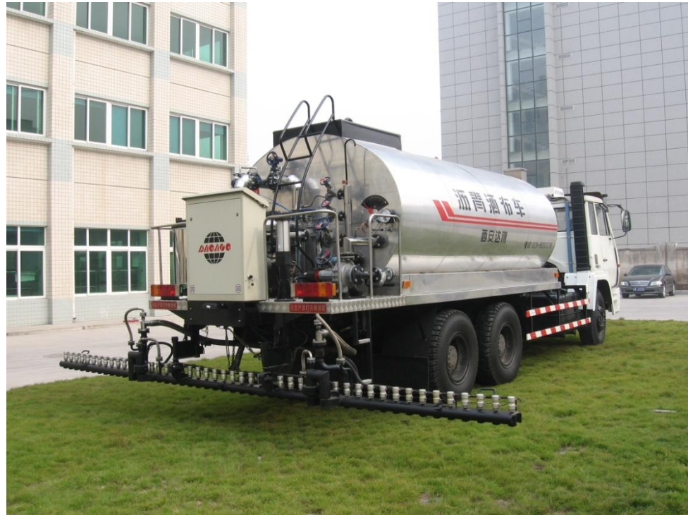
Figura 16. Equipo utilizado para riego de Emulsión
