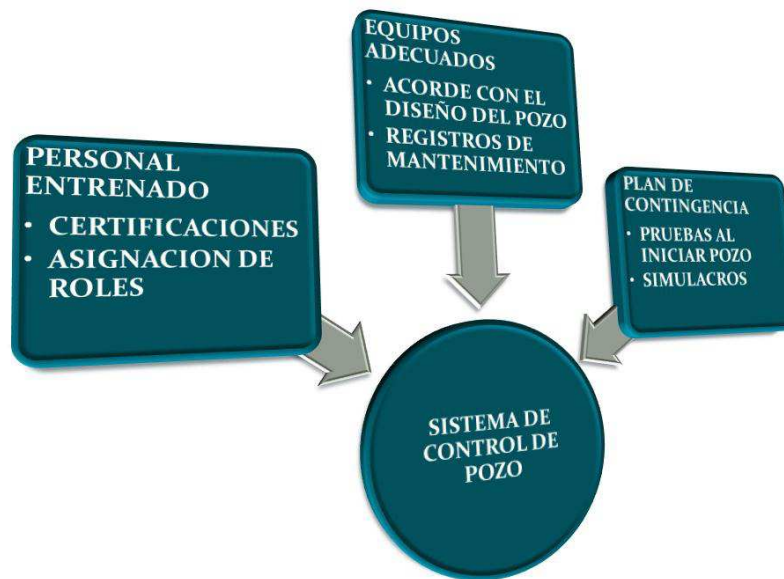
Figura 25. Componentes Del Sistema De Control De Pozo
