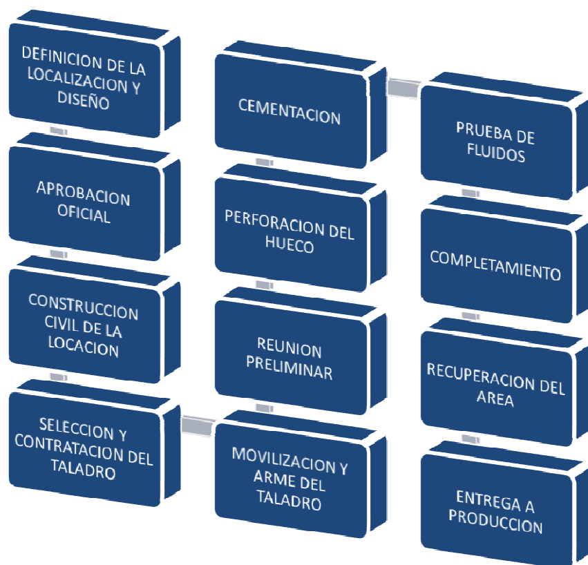
Figura 15. Proceso De Perforación
