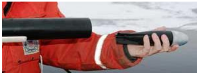
FIGURA 89: XBT, sensor de temperatura y velocidad del sonido con la profundidad para estudios de batimetría.
