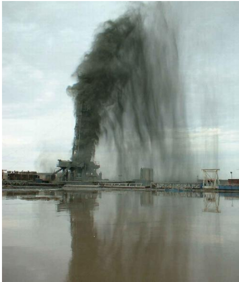
FIGURA 61: Blowout generado por SWF Turmekistan.
