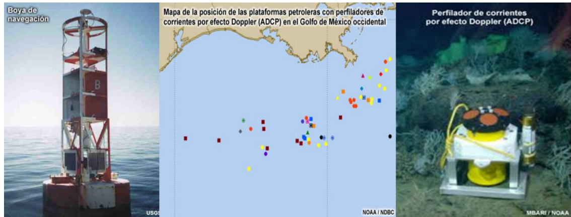
FIGURA 79: Correntómetros fijos y mapa geográfico para caracterizar zonas a nivel local o regional.
