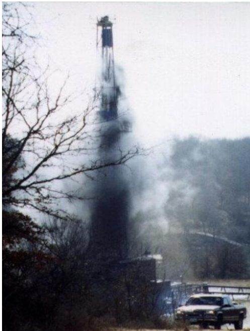
FIGURA 62: Blowouts generado por SWF Texas EU.
