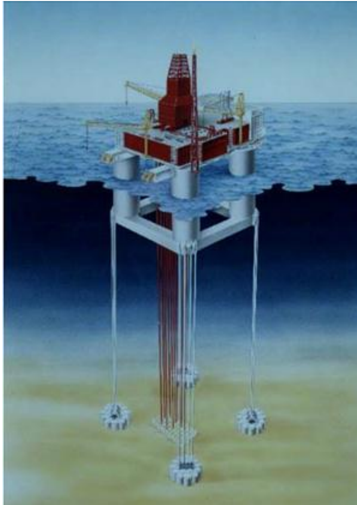
FIGURA 45: Anclaje de plataformas al fondo marino.
