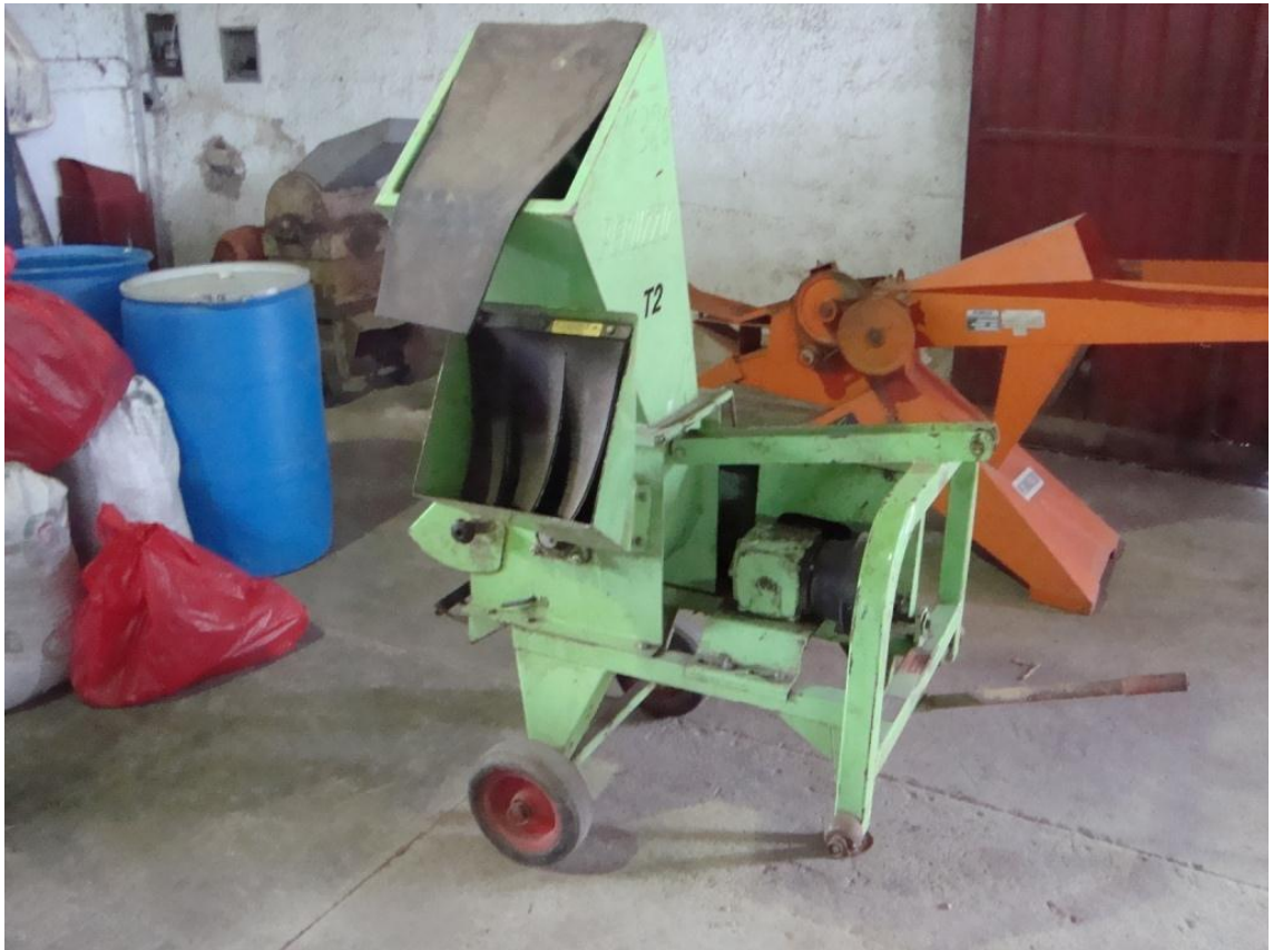
Figura 20. Molino triturador de martillos de enganche a tres puntos del tractor para uso ocasional.
