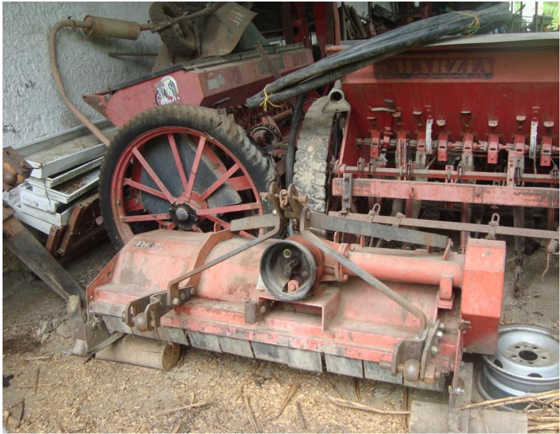
Figura 9. Desbrozadora accionada con tractor, tritura residuos en montón y/o en lotes de cultivos utilizados con labranza mínima y plantío directo
