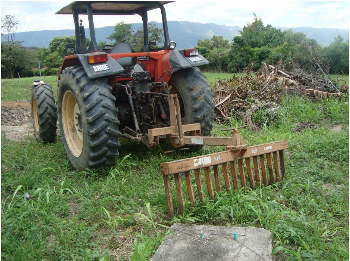
Figura 8. Tractor Same 110 HP y rastrillo de púas utilizados en el volteo de la línea de compost.
