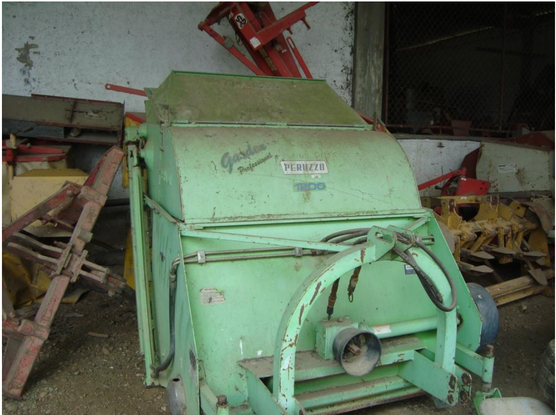
Figura 21. Podadora-recolectora de enganche al tractor para uso en lotes del parque tecnológico.
