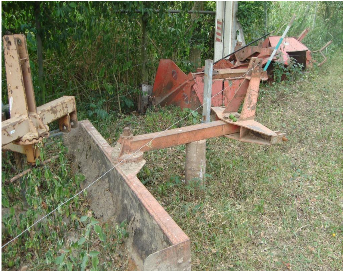
Figura 10. Pala niveladora de enganche a tres puntos de tractor utilizada en la nivelación.
