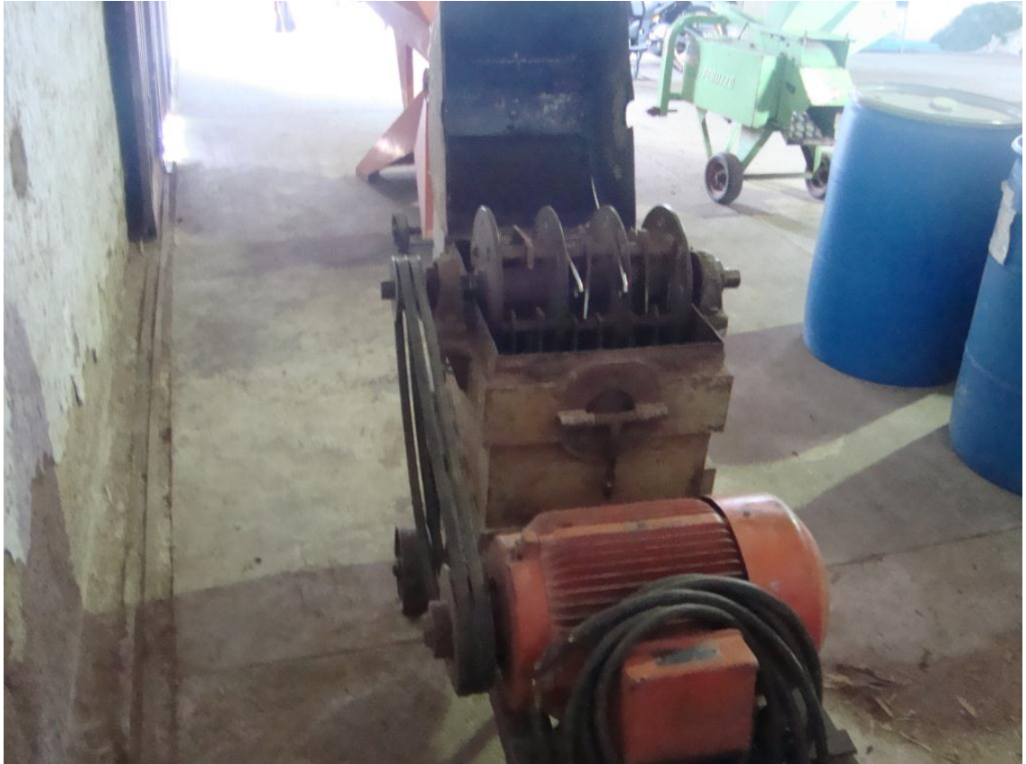
Figura 11. Molino de martillos en mantenimiento y montaje del motor eléctrico
