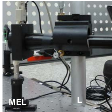
Figura 20. Fuente de generación de haces con momento angular orbital, láser (L) derecha, Modulador espacial de luz (MEL) izquierda.
