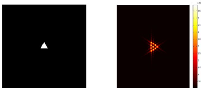
Figura 23. Patrón de difracción resultante al difractar un haz MAO con CT, m=3 , a través de una abertura triangular.
