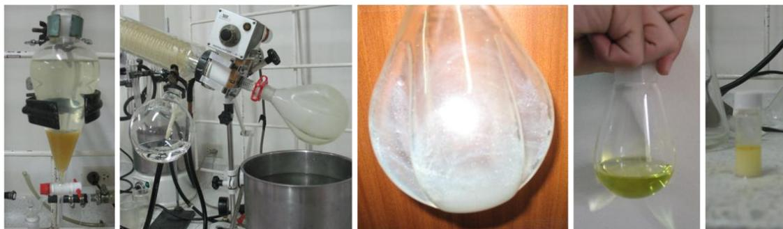
\*De izquierda a derecha: decantación, rotoevaporación, concreto, dilución en etanol, absoluto final.
