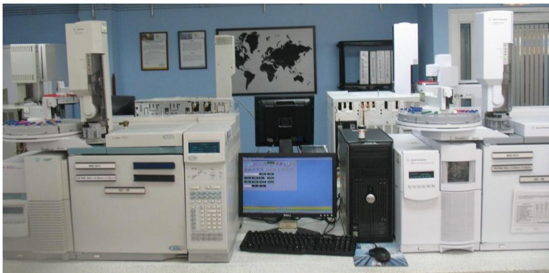
\*De izquierda a derecha: GC-MS (*Agilent Technologies* 6890 Plus – 5973N), computador, GC-MS (*Agilent Technologies* 6890N – 5975A).
