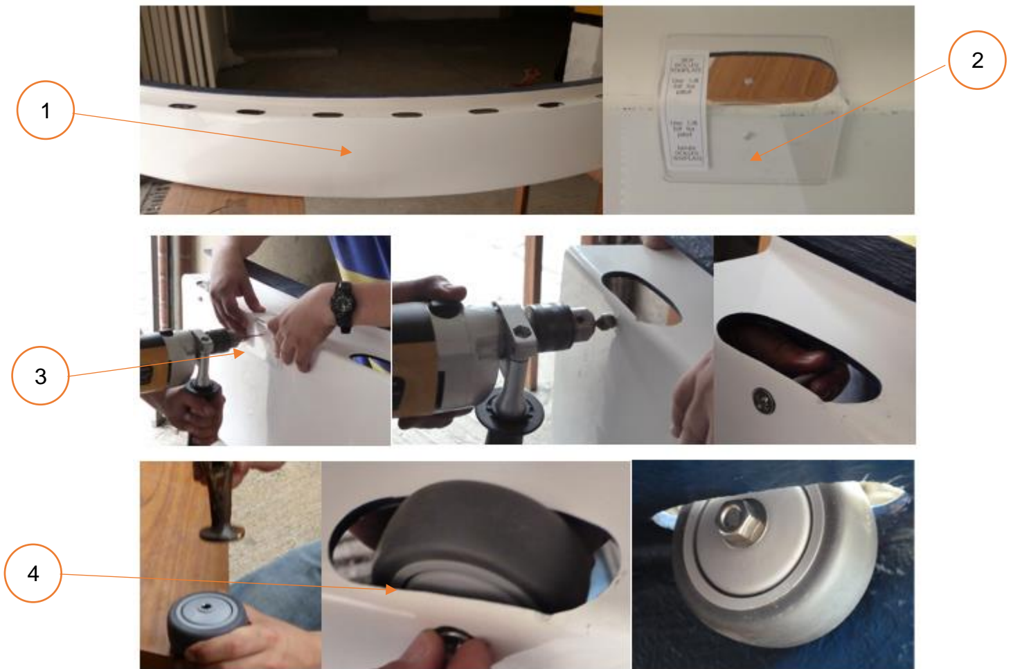
Figura 32 Montaje de las llantas
