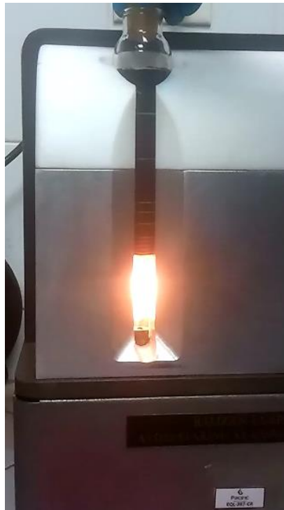
Figura 12. Prueba de demulsificante en presencia de campo eléctrico en equipo de deshidratación electrostática piloto
