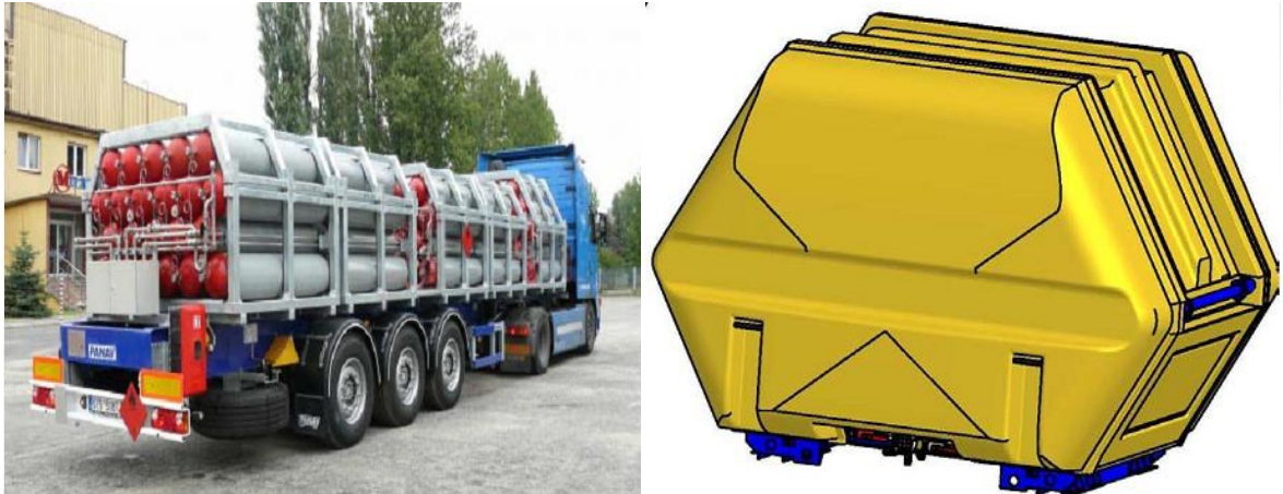
Figura 17. Baterías de almacenamiento móvil horizontal y modular
