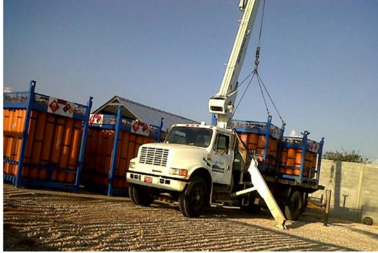
Figura 20. Vehículo con su grúa para alzar y bajar las canastas de GNC
