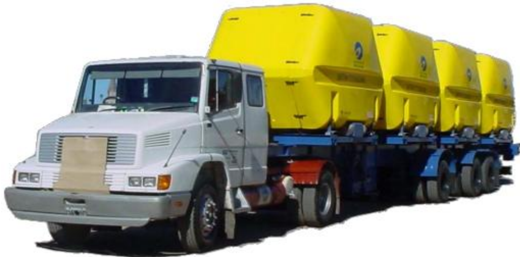
Figura 34. Vehículo para transporte GNC (4 módulos MAT)
