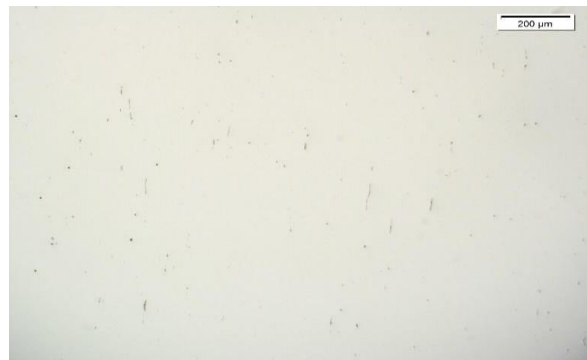
Figura 8. Micrografía sin ataque a 100X del espécimen Blanco en la sección L.
