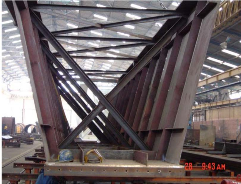
**Figura 126. Foto de los rigidizadores (acero ASTM A 36)**
