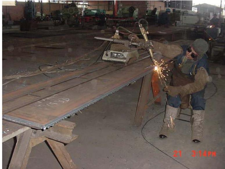
**11.5 Montaje (aplicación de soldadura).** Es llevado a cabo de acuerdo a los WPSs calificados y con personal debidamente calificado, proveyendo la sanidad de la junta.
