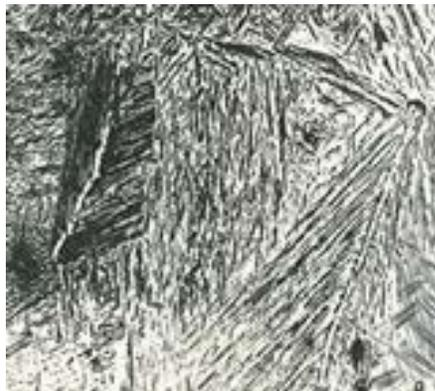
La martensita tiene una dureza de 50 a 68 Rc, resistencia a la tracción de 170 a 250 Kg. /mm<sup>2</sup> y un alargamiento del 0.5 al 2.5 %, muy frágil y presenta un aspecto acicular formando grupos en zigzag con ángulos de 60 grados.
