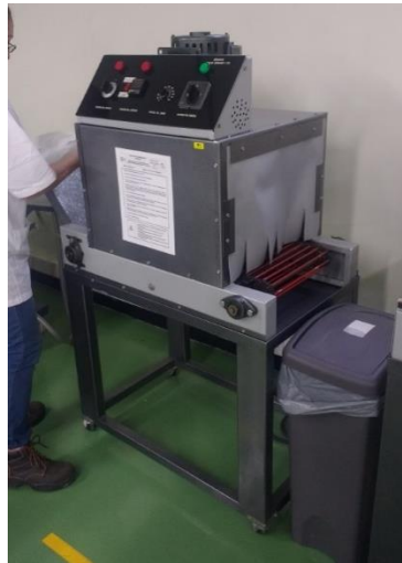
Figura 12. Empacadora HERNANDPACK (Túnel). Foto de registro.
