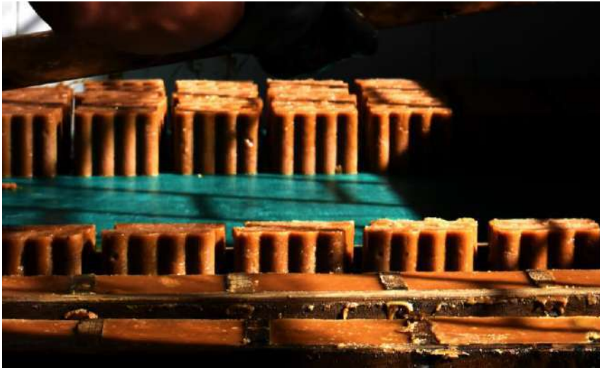
Figura 55 - Desmoldeo de panela
