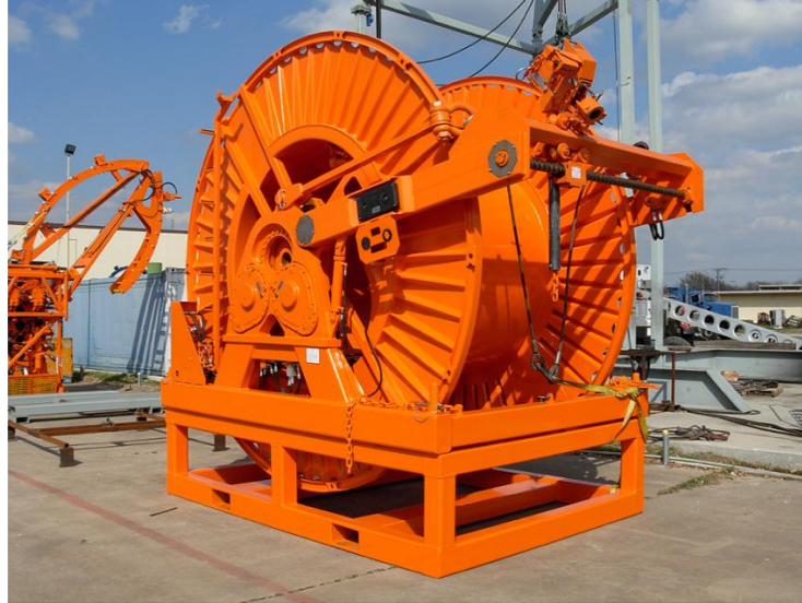
Figura 8. Soporte del carrete de tubería en locación
