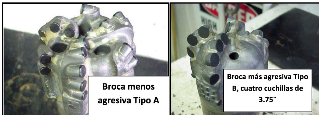
Figura 40. Diseño de brocas usado en pruebas de vibraciones
