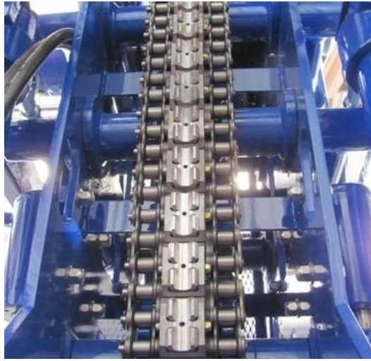
Figura 11. Cadenas de tensión ubicadas en el Gooseneck en el cabezal inyector
