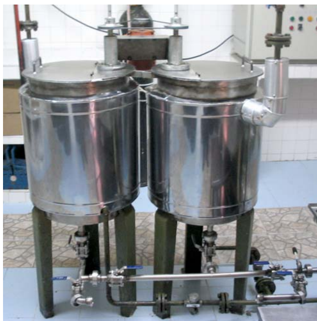
Figura 3.4b Reactor utilizado para la reacción de transesterificación a escala piloto 35 kg de sustrato.
