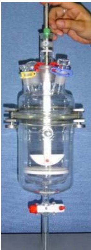
Figura 3.4a Reactor utilizado para la reacción de transesterificación a escala de 1000 g de sustrato.
