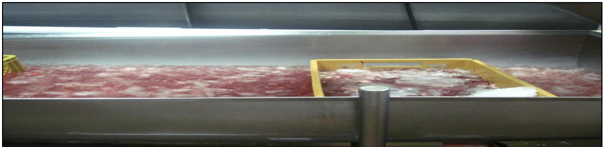
FOTO 13. Chiller de hígado y corazón.
