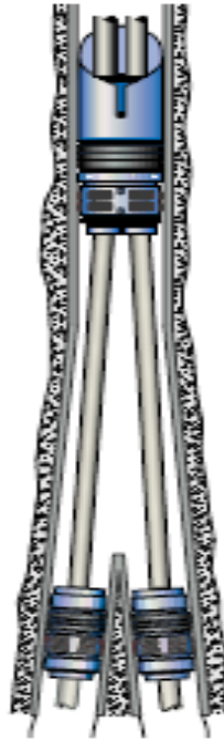
Figura 7. Pozo multilateral con integridad de presión alcanzada con el revestimiento.
