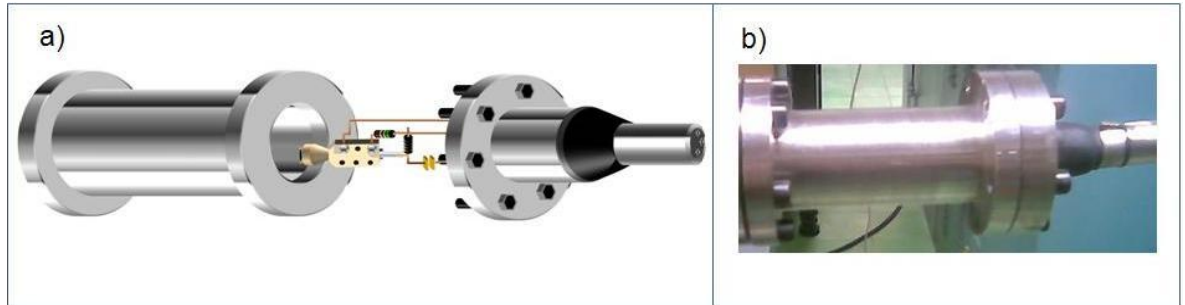
Figura 11. a) Conexión de la cámara del detector con la tapa del tubo de tiempo de vuelo b) Fotografía de la cámara del detector y la tapa del tubo de tiempo de vuelo ensamblados.
