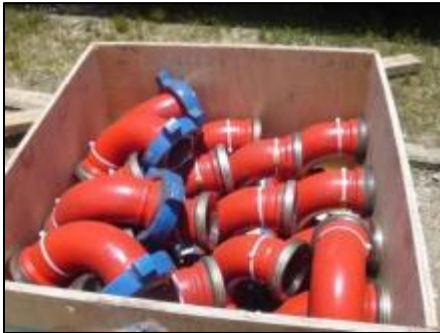
Figura 30. Tubería y accesorios roscados tipo unión de Golpe de 4" figura 206
