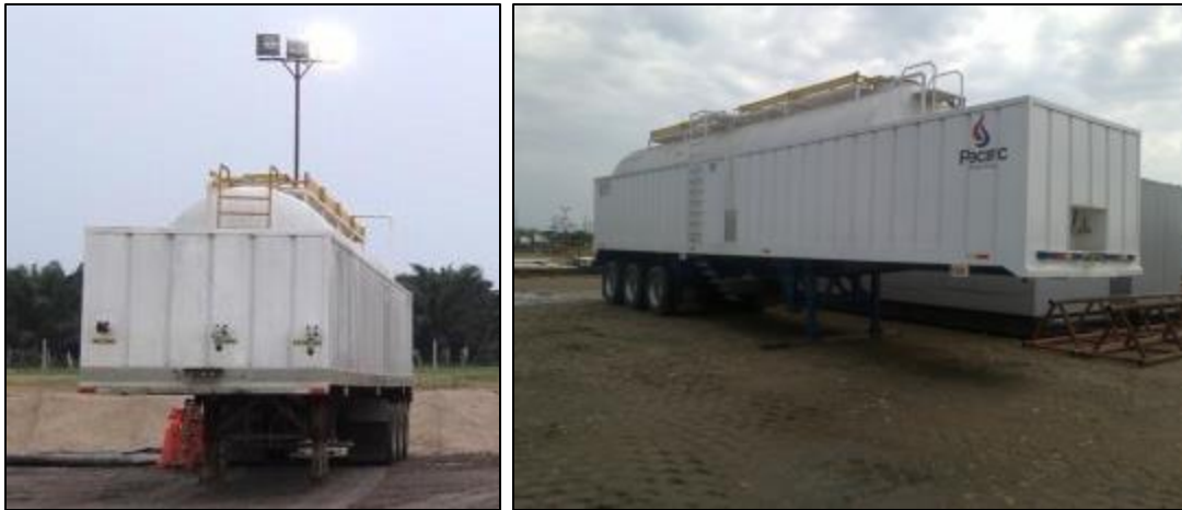
Figura 85. Tanque de Diesel con dique y filtros montado sobre Trailer
