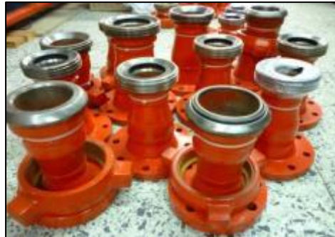
Figura 30. Tubería y accesorios roscados tipo unión de Golpe de 4" figura 206
