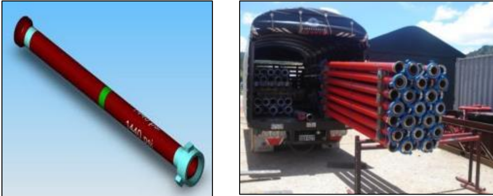
Figura 27. Tubería roscada tipo unión de Golpe
