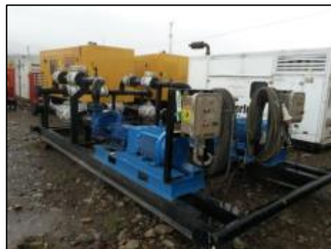
Figura 76. Skid de dos Bombas centrífugas con colectores de succión y descarga
