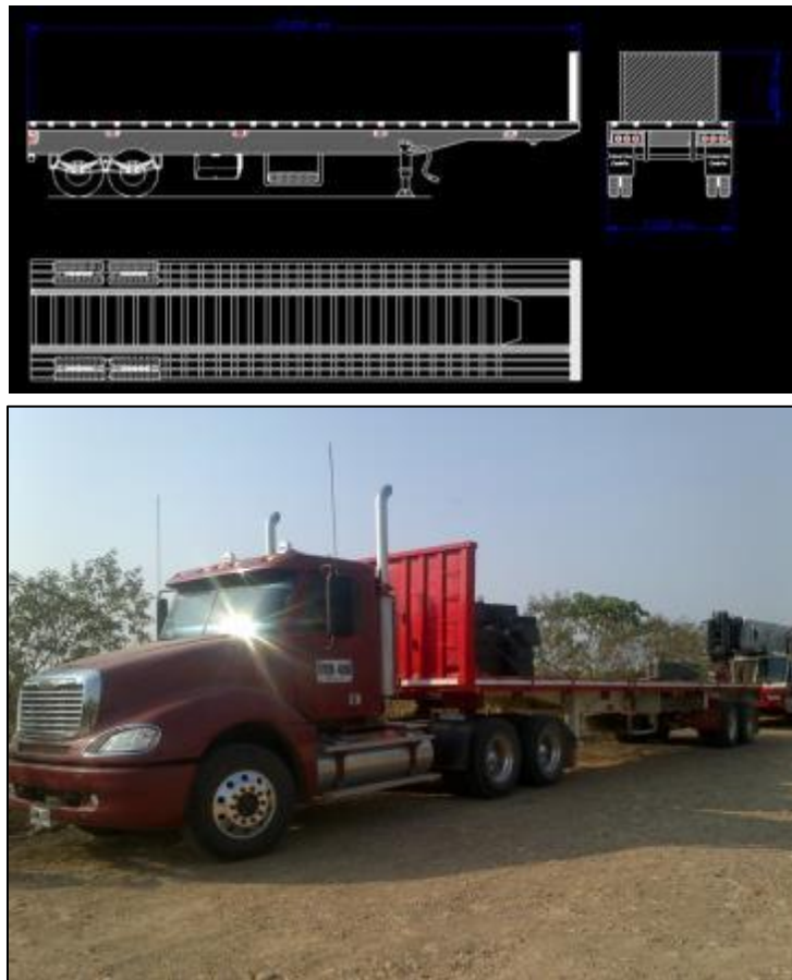
Figura 3. Dimensiones representativas de un semirremolque tipo cama-alta
