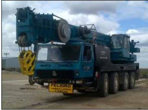
Figura 4. Fotografía Grúa con capacidad nominal de izaje de 70 Ton
