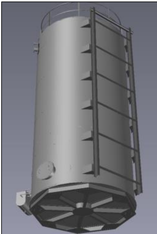
Figura 50. Fotografía y diagrama de un Gun Barrel con Skid en base y para ser transportado adecuadamente
