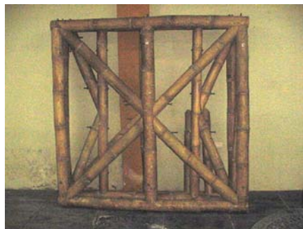
Fotografía 40. Paneles listos para pruebas mecánicas
