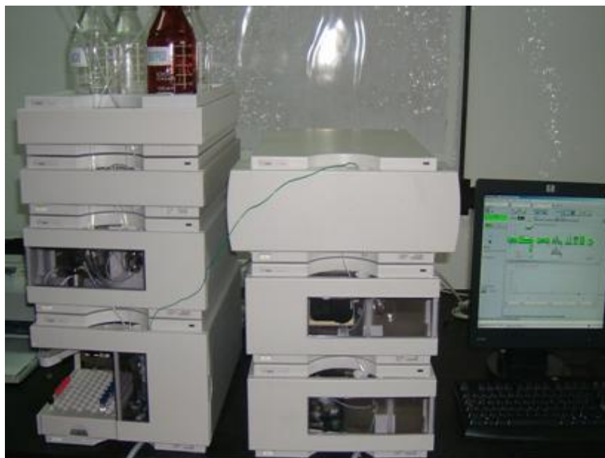
Figura 7. Cromatógrafo líquido de alta eficiencia Agilent 1100 Series , equipado con un DAD y un FLD.
