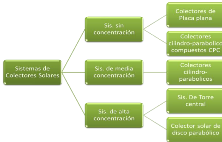
Figura 13. Esquema de la clasificación de colectores solares.
