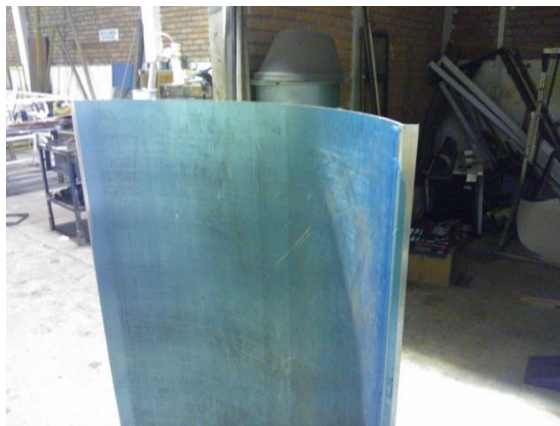
Figura 85. Lámina de aluminio de 3mm con forma parabólica.
