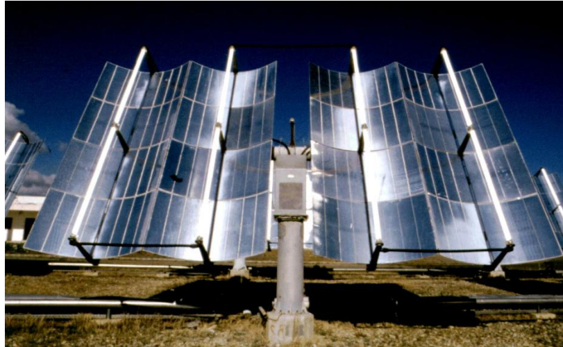
Figura 17. Colector cilindro-parabólico Helioman con seguimiento en dos ejes
