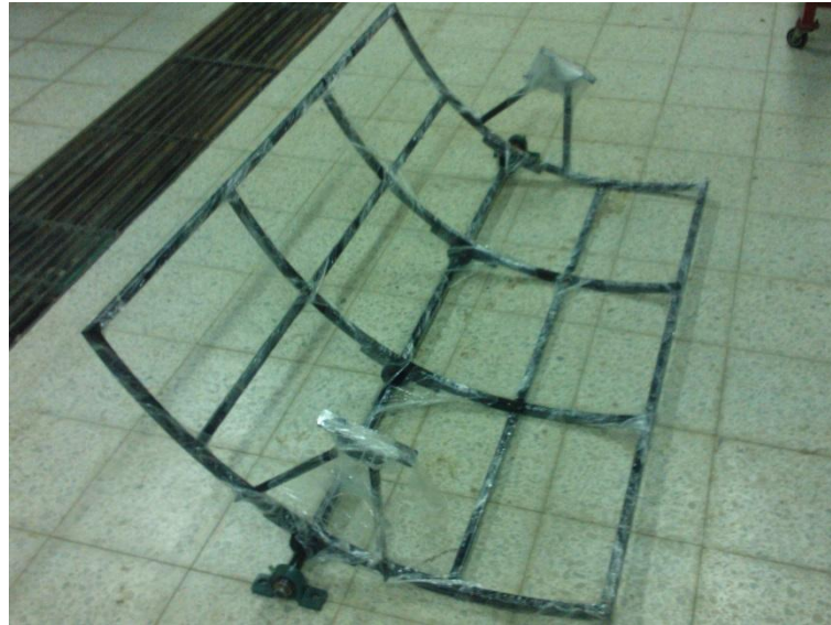
Figura 83. Esqueleto soporte para la cubierta reflectora.
