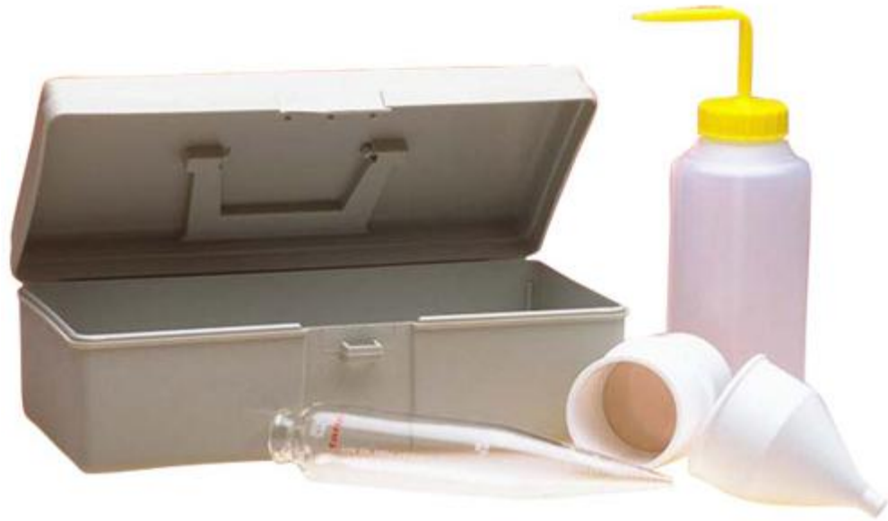
Figura 6. Arenómetro ó Prueba de la Zanahoria.
