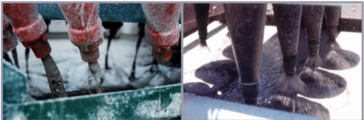
Figura 21. Tipo de Descarga de un Hidrociclón.
