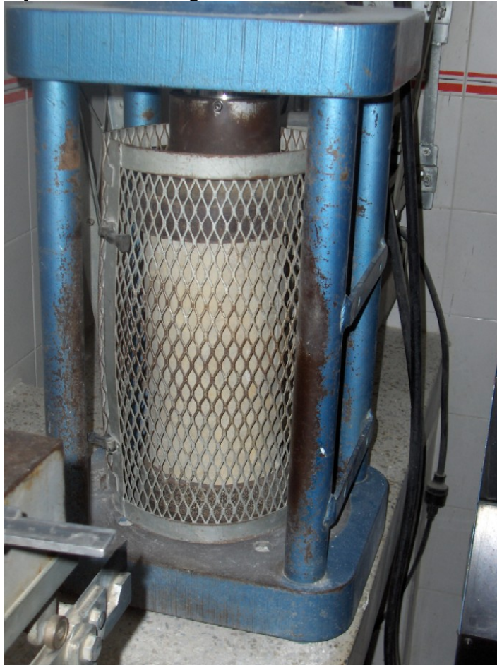
Figura 54. Ensayo a cilindros testigos de la muestra 156 del 19 de abril del 2005
