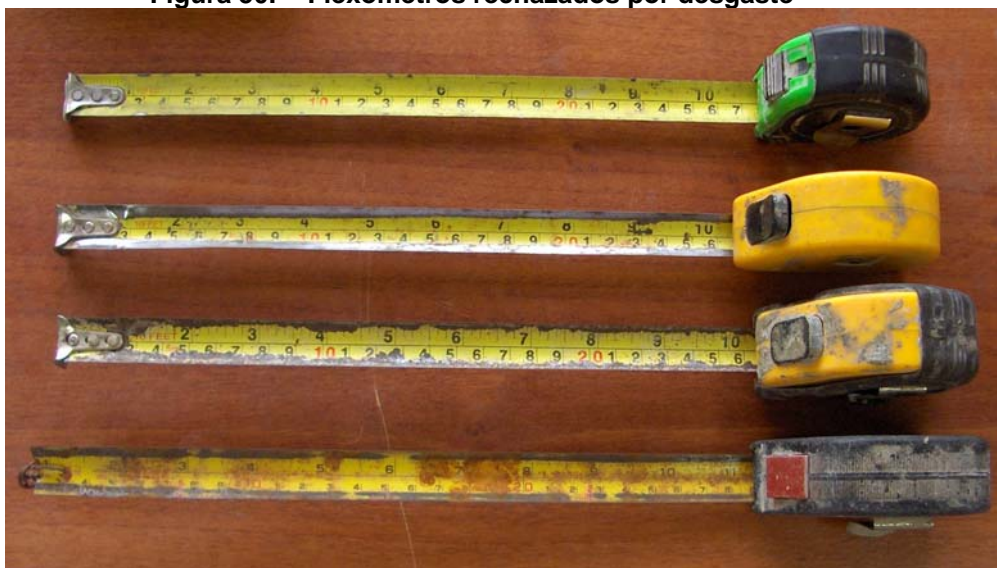
Figura 50. Flexómetros rechazados por desgaste
