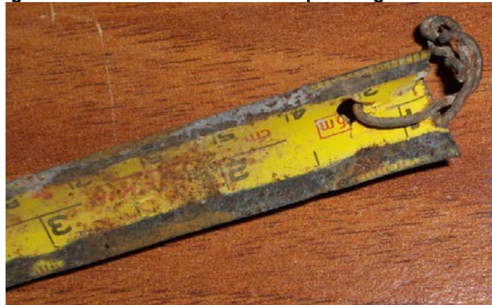
Figura 51. Flexómetro rechazado por desgaste total
