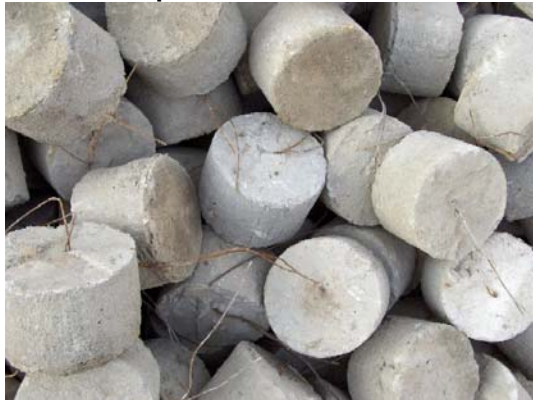
Figura 11. Panelas de 7 cm para recubrimiento inferior de cimentación
