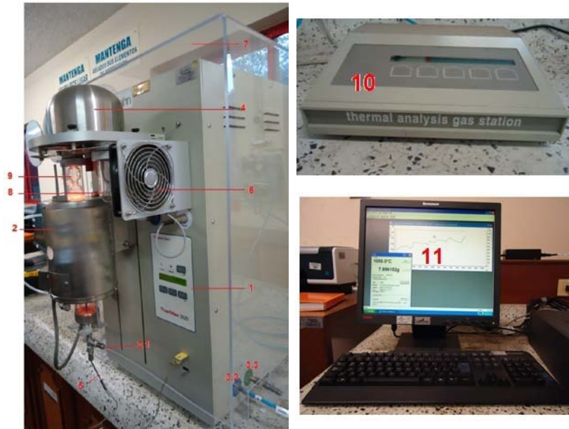
Figura 3. Componentes de la balanza termogravimétrica Thermax 300 Forma del corte de las probetas
