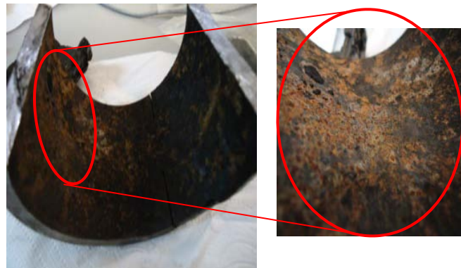
Figura 7. Corrosión generalizada (oxidación) de la superficie externa del tubo retirado de servicio del horno H4100
