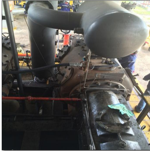
Figura 7. Bloque Compresor Ajax DPC-600
