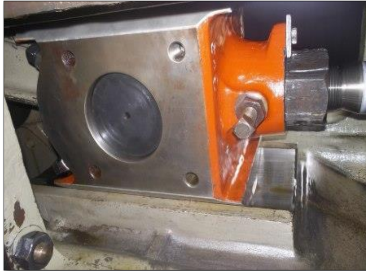
Figura 13. Cruceta del Compresor Ajax DPC-600
