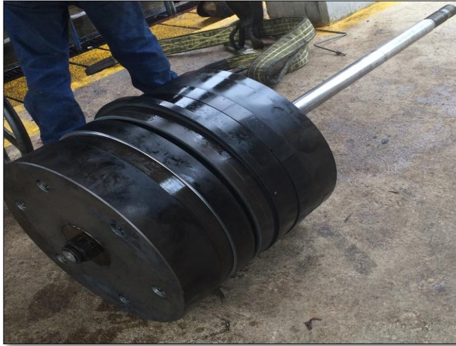
Figura 9. Pistón del Compresor Ajax DPC-600
