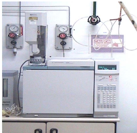
Foto 6. Cromatógrafo de gases Fuente: Laboratorio de análisis PVT – ICP
