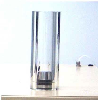
Foto 9. Cilindro con pistón cónico Fuente: Laboratorio de análisis PVT – ICP
