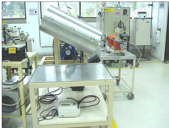
Foto 4. Celda de recombinación Fuente: Laboratorio de análisis PVT – ICP
