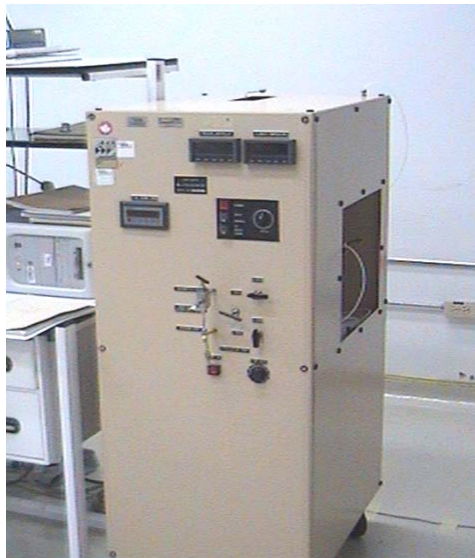
Foto 5. GOR Apparatus Fuente: Laboratorio de análisis PVT – ICP
