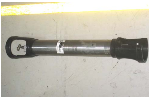
Foto 3b. Cilindro para aceite tipo Leutert 5 Fuente: Laboratorio de análisis PVT – ICP
