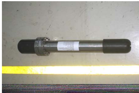
Foto 3a. Cilindro para aceite tipo Leutert 4 Fuente: Laboratorio de análisis PVT – ICP
