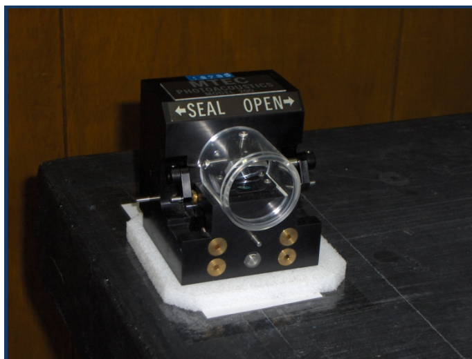
Figura 8. Celda PAS modelo MTEC 200
