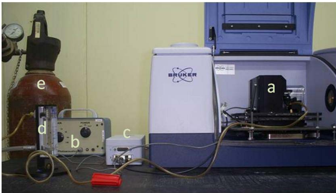
Figura 7. Sistema PAS acoplado al equipo IR Tensor 27 marca Bruker
