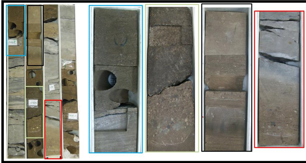
Figura 25 Caballos Inferior. 3439 – 3434 ft. Secuencias granodecrescientes desde conglomerados y areniscas conglomeráticas hasta areniscas de tamaño muy fino y lodolitas. Se evidencian superficies de reactivación
