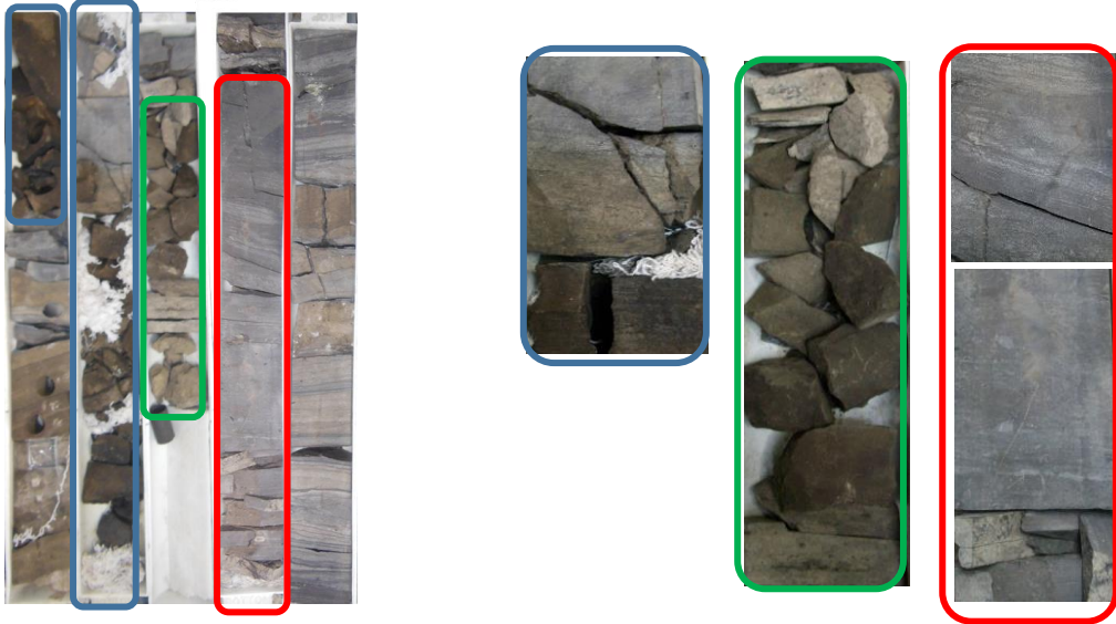
Figura 16 Caballos Superior. 3110 – 3101.4 ft. Azul) Arenisca de grano medio laminada. Verde) Arenisca de grano muy fino a fino con baja impregnación. Rojo) Lodolita laminada y bioturbada.
