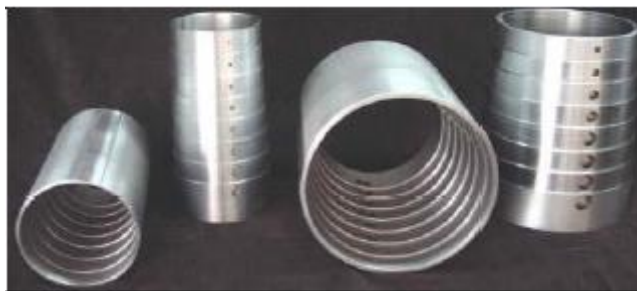
Figura 5. Patrones tubulares con discontinuidades artificiales.
