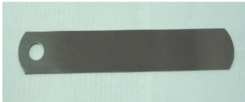
Figura 51. Galga con espesor original de 38 \mu m
