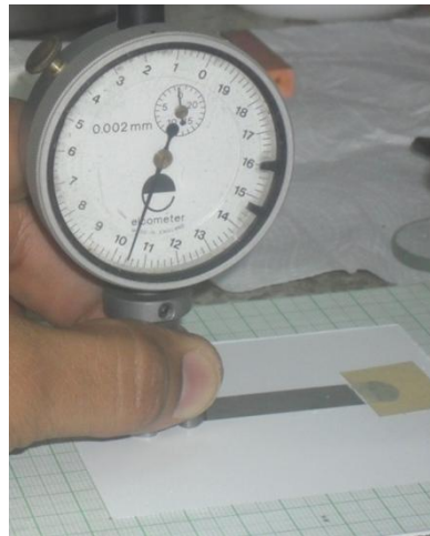
Figura 53. Medición de la galga con el indicador de caratula
