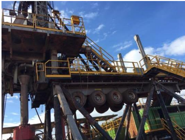
Figura 13. Subestructura de soporte
