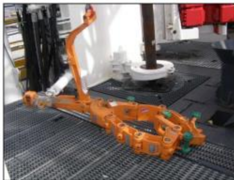
Figura 23. Llave de potencia para broca
