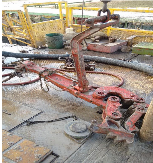
Figura 9. Llaves de potencia implementadas en un taladro convencional
