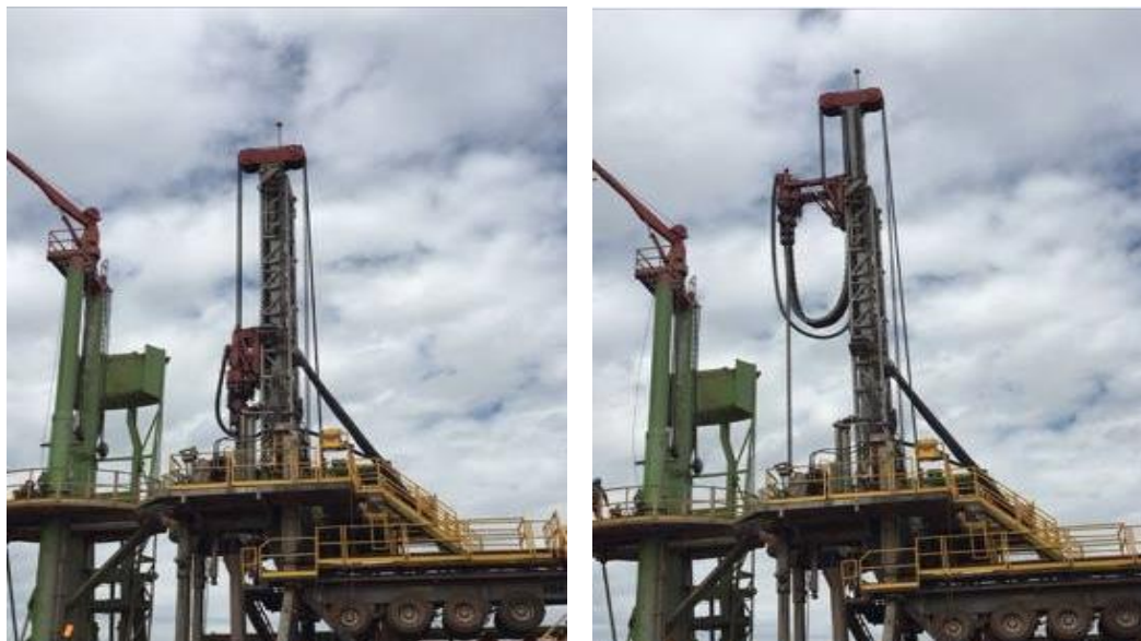
Figura 24. Torre telescópica dentro y fuera de la sección fija del mástil
