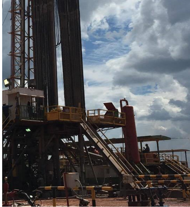
Figura 7. Rampa para tubería de un taladro convencional
