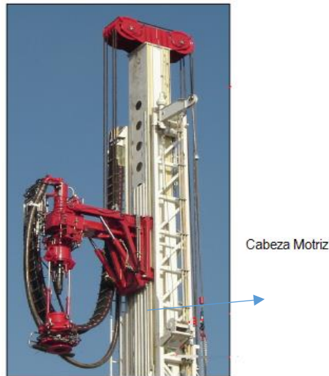
Figura 25. Cabeza motriz que desplaza el Top Drive.
