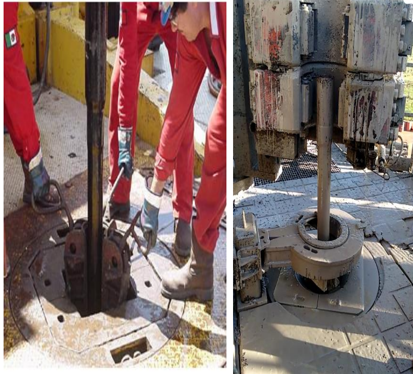
Figura 38. Cuñas de los dos tipos de taladros
