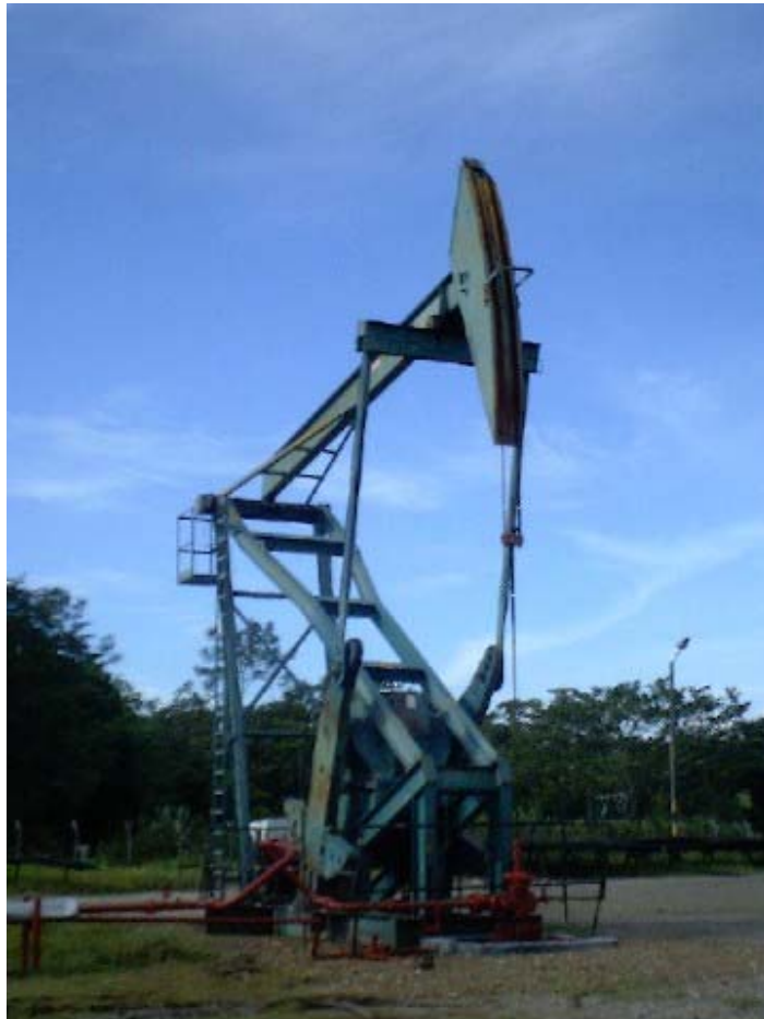
Figura 1.5 Unidad de Bombeo Mecánico, Lufkin M 456 D 256-144
