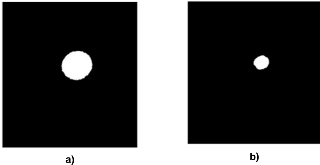
Figura 45. Imagen binarizada a). Binarización al 13.53% de la intensidad máxima b). Al 50%
