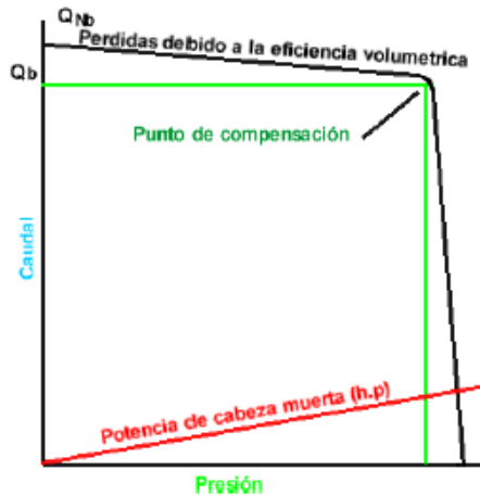
Grafica 2. Curva de desempeño del compensador para bomba variable de pistones axiales
