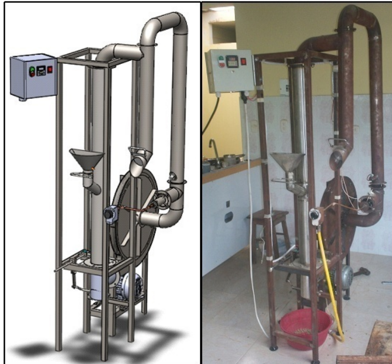
Figura 33. Diseño y construcción tostadora de 141[g] de café
