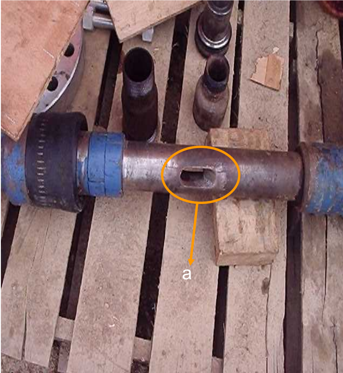
Figura 19b. Orificio de salida de la grava, platinas gravel packer (Segunda sección del gravel packer ).
