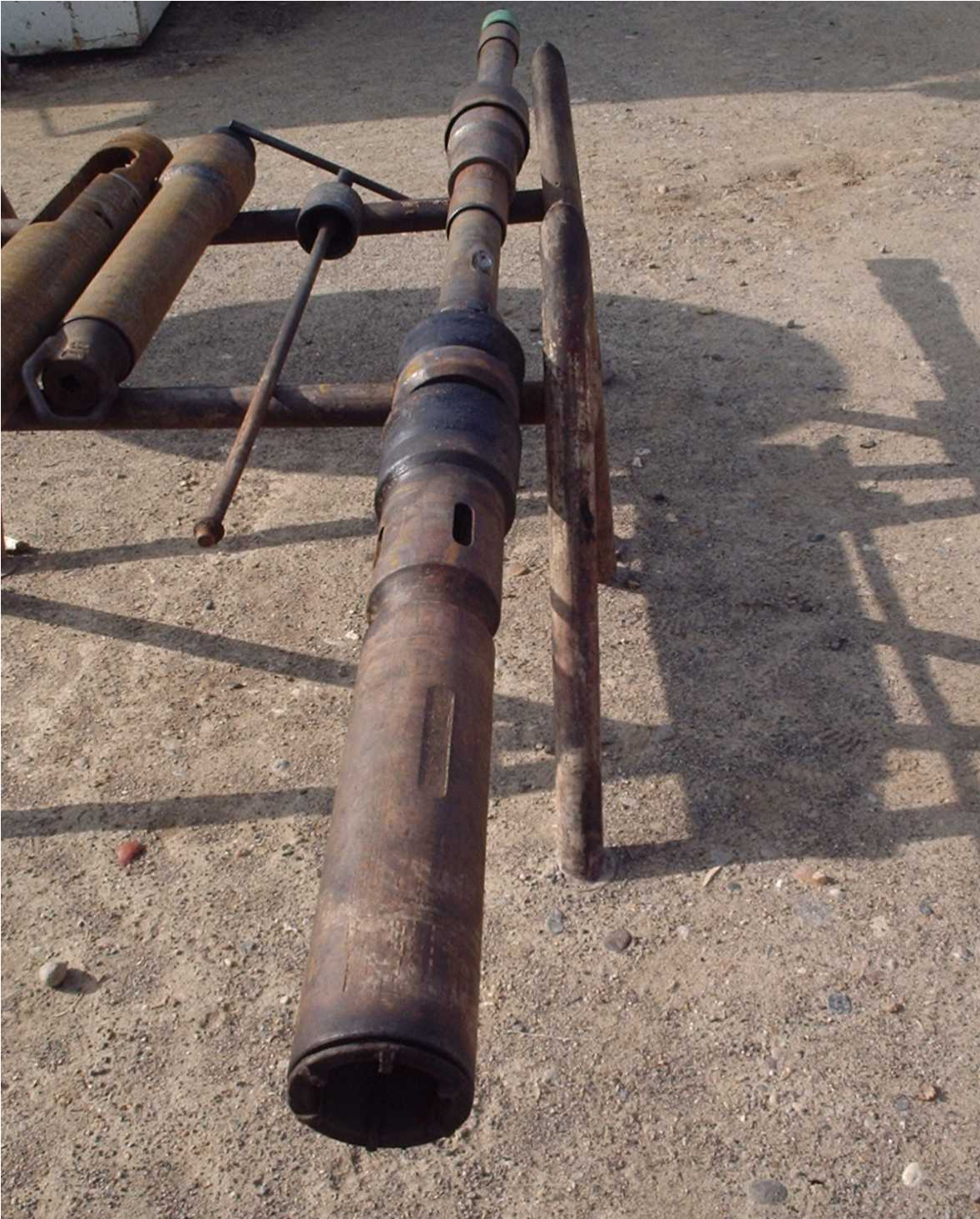
Figura 18. Empaquetador de grava ( gravel packer )
