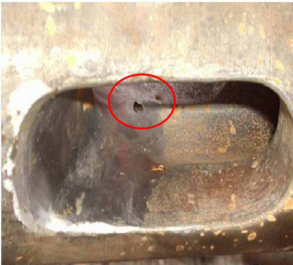
Figura 31. Wash out (erosión) en herramienta empaquetadora de grava.
