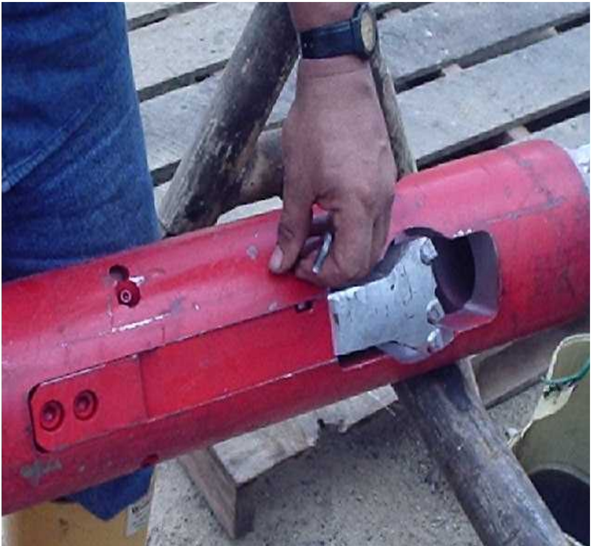
Figura 28. Ensanchador convencional tipo “pata de oso”
