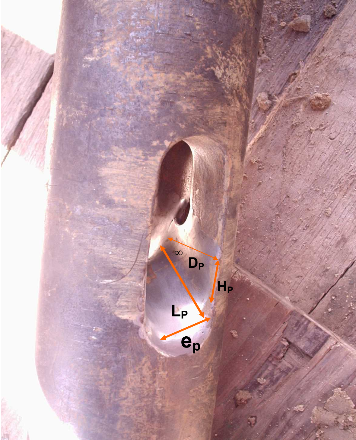
Figura 10. Dimensiones de la platina del Gravel Packer .
