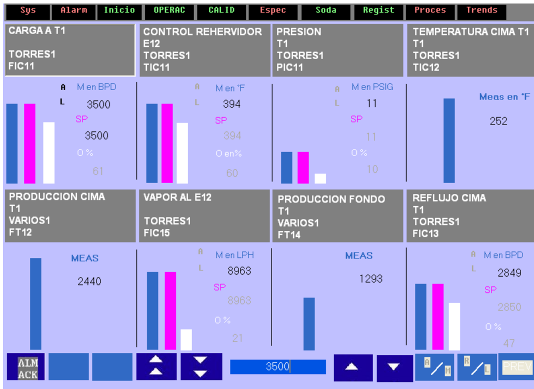
Figura 21. Valores en la torre 1 después de cambio de “SetPoint” de la Carga
