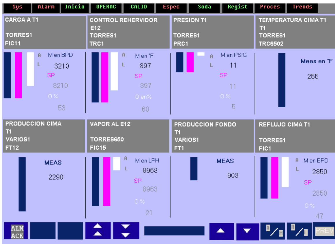
Figura 17. Despliegue gráfico del DCS emulado recibiendo/enviando información.
