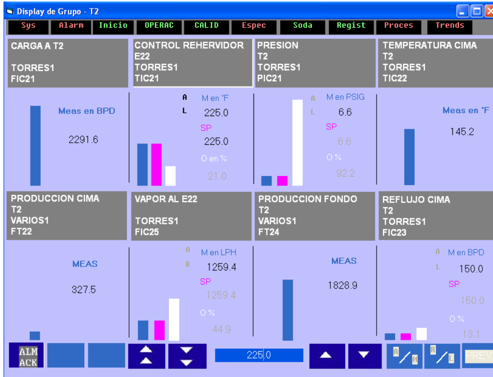
Figura 27. Valores de la torre 2 después del cambio de “SetPoint” de la temperatura de fondo
