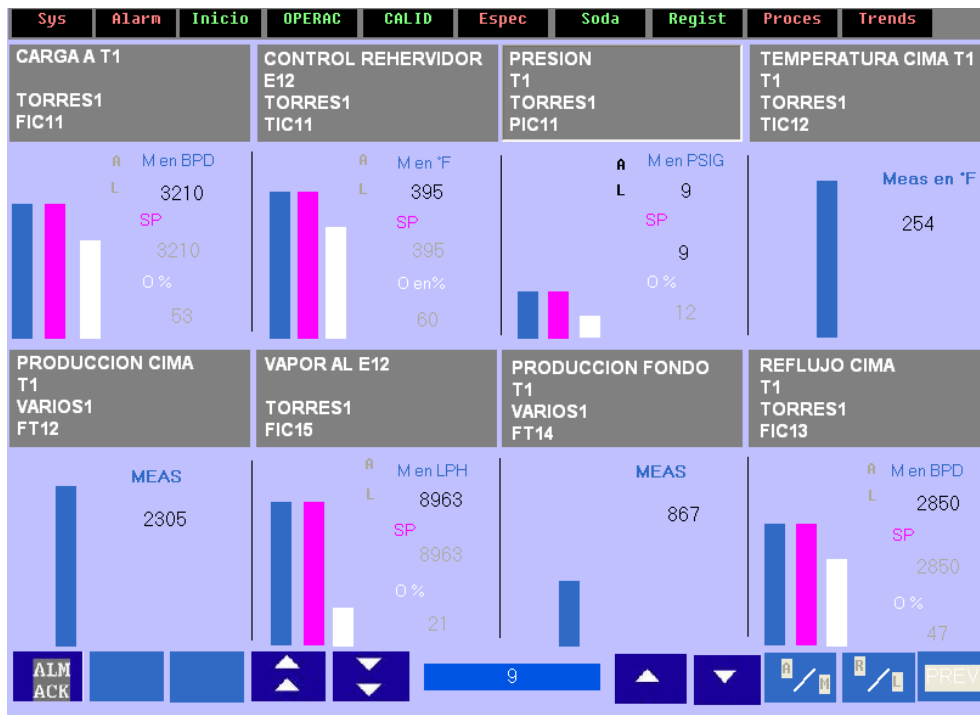
Figura 24. Valores al estabilizarse la torre 1 después del cambio del "SetPoint" de la Presión de cima
