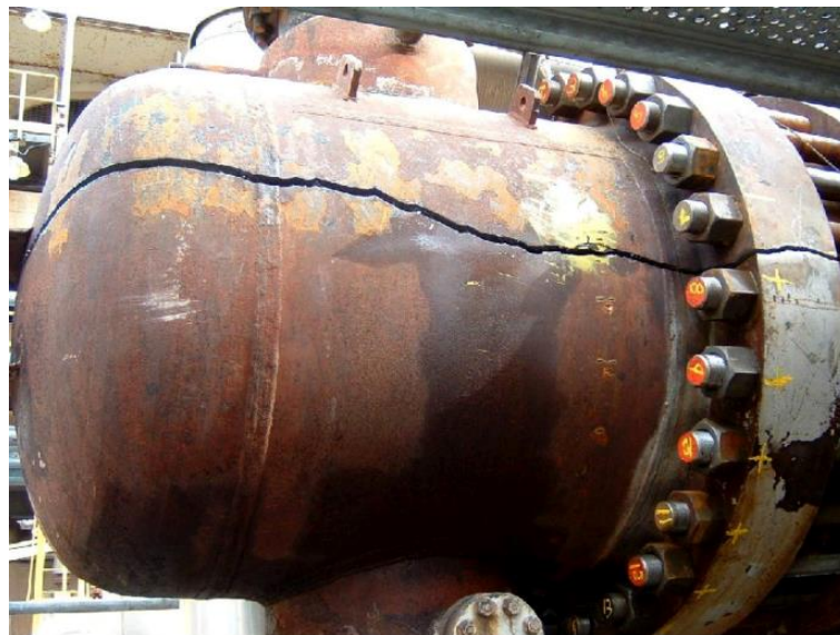
Figura 16. Fractura Frágil por fragilización por temple en Cabezal de un Intercambiador
