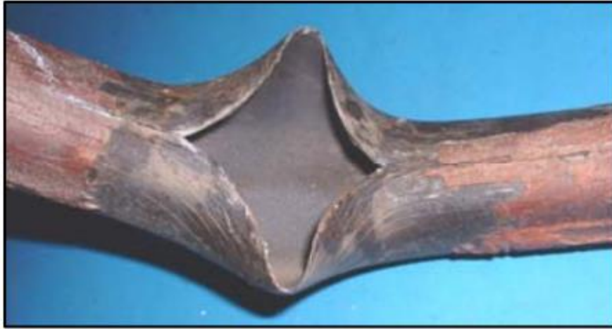
Figura 19. Sobrecaentamiento a corto plazo
