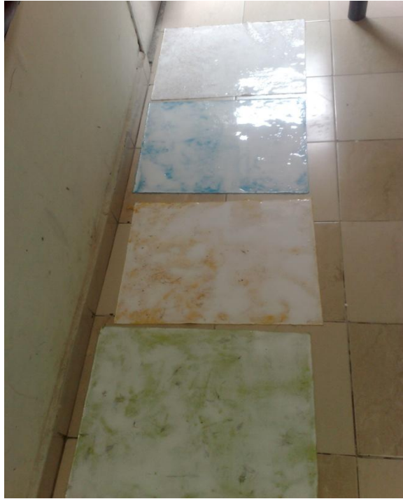
Figura 39. Proceso de Secado del papel a temperatura ambiente.
