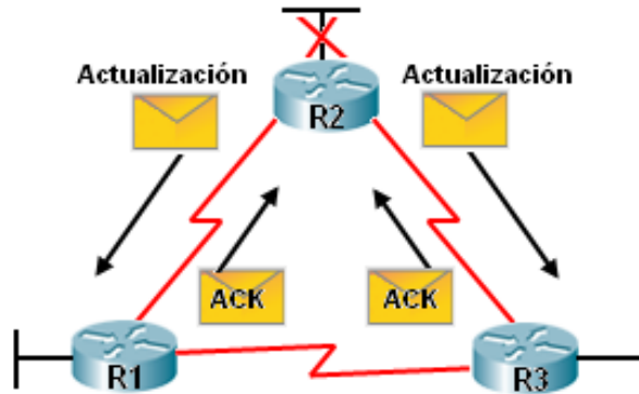
Figura 28. Diagrama de tipo de mensaje EIGRP Ack y Update
