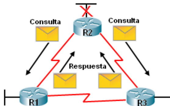
Figura 29. Diagrama de tipo de mensaje EIGRP Query y reply
