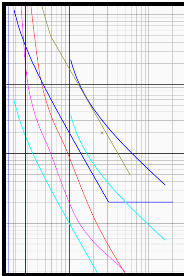
Figura 7. Pérdida de la coordinación de protecciones para el lateral 5 con falla monofásica
