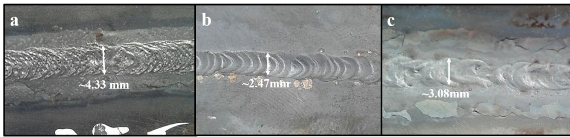
Figura 3. Cordón de soldadura realizado con llama: a) oxidante, b) neutra y c) reductora.
