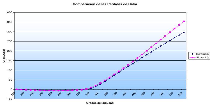
Figura 50. Comparación de las pérdidas de calor
