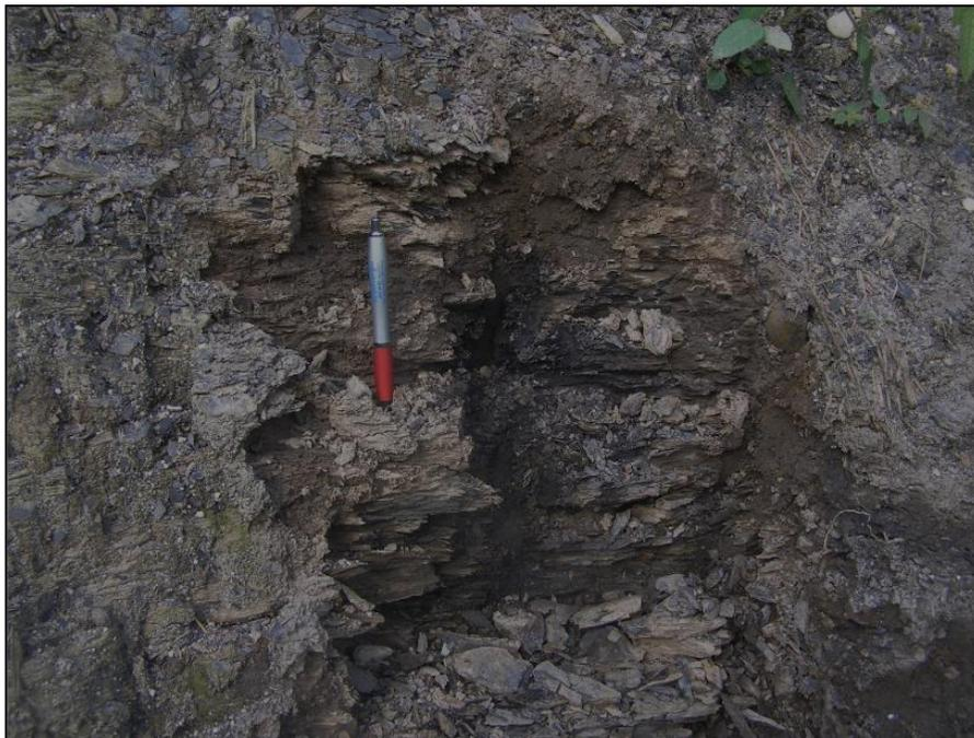
Ilustración 8: Fotografía del tipo de material presente en la superficie de falla (lutitas grises oscuras, altamente diaclasadas y meteorizadas).
