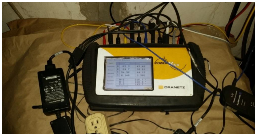
Figura 31. Analizador de redes Power Visa 440 en funcionamiento en la acometida del edificio Daniel Casas
