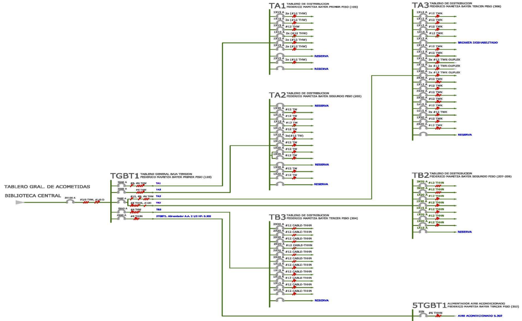
Figura 6. Diagrama Unifilar Ed. Mamitza Bayer TG 1
