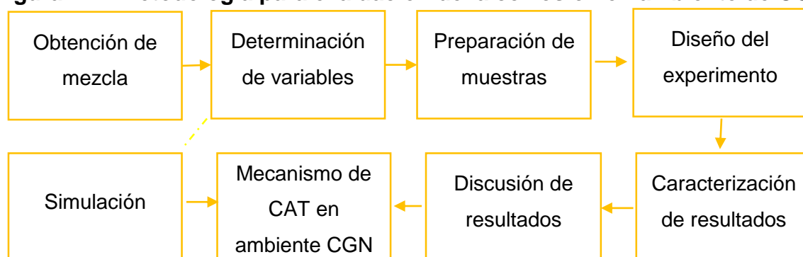
Figura 117. Metodología para evaluación de la corrosión en ambiente de CGN
