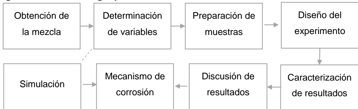
Figura 147. Metodología para evaluación de la corrosión en una caldera
