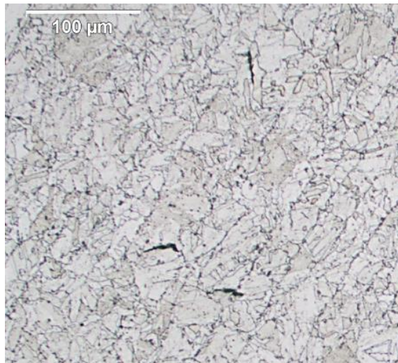
Figura 35. Micrografía del acero P91 después de 200 h de oxidación a 550 °C (100 X)
