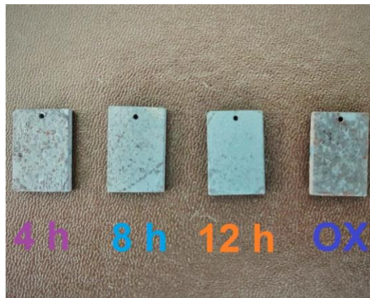
Figura 174. Textura superficial de las capas de óxidos formadas sobre los distintos recubrimientos tras 100 h de oxidación a 650 °C
