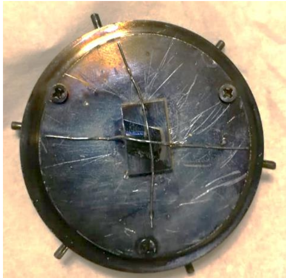
Figura 164. Porta sustrato con depósito de Y_2O_3 sobre el acero P91 y una porción de oblea de silicio, ambos sostenidos por un alambre soldado de Cr-Ni
