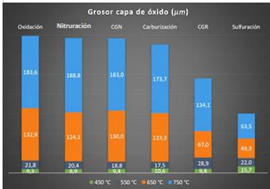
Figura 142. Comparación del mayor grosor de la capa de óxido alcanzado para cada temperatura evaluada en cada ambiente de estudio
