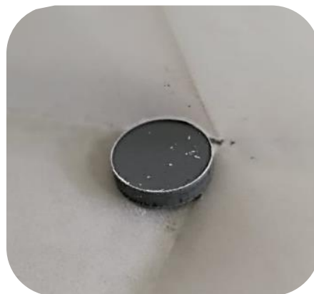
Figura 162. Pastilla de óxido de itrio obtenida para estudio de recubrimiento del acero P91
