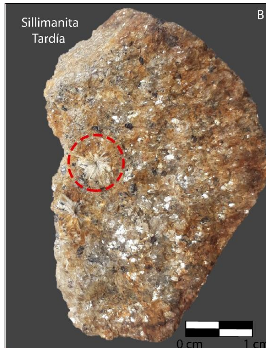
Figura 13. Muestra E3-M1. Sillimanita variedad fibrolita nucleando de forma radial, de color blanco, dentro del círculo rojo.
