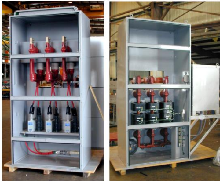
Cubículo de terminal de línea
