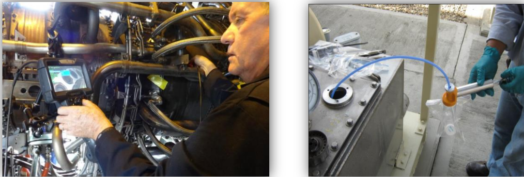
Figura. 25. Análisis de Boroscopio en Turbina y Análisis de Aceite
