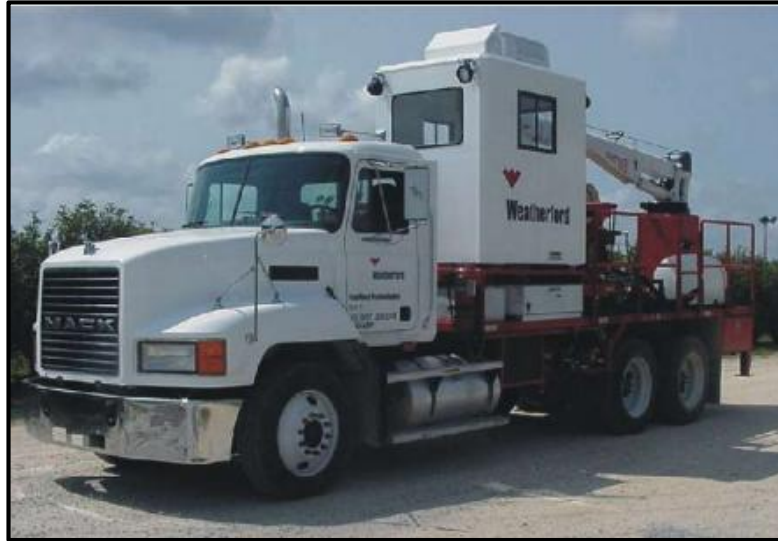
Figura 69. Camión de transporte de Unidad de Sistema de Tubería Capilar.
